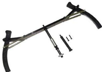
⊕ Cône pour petits camions, diamètre intérieur du trou. 36 mm, dia. max. 175 mm avec bride
